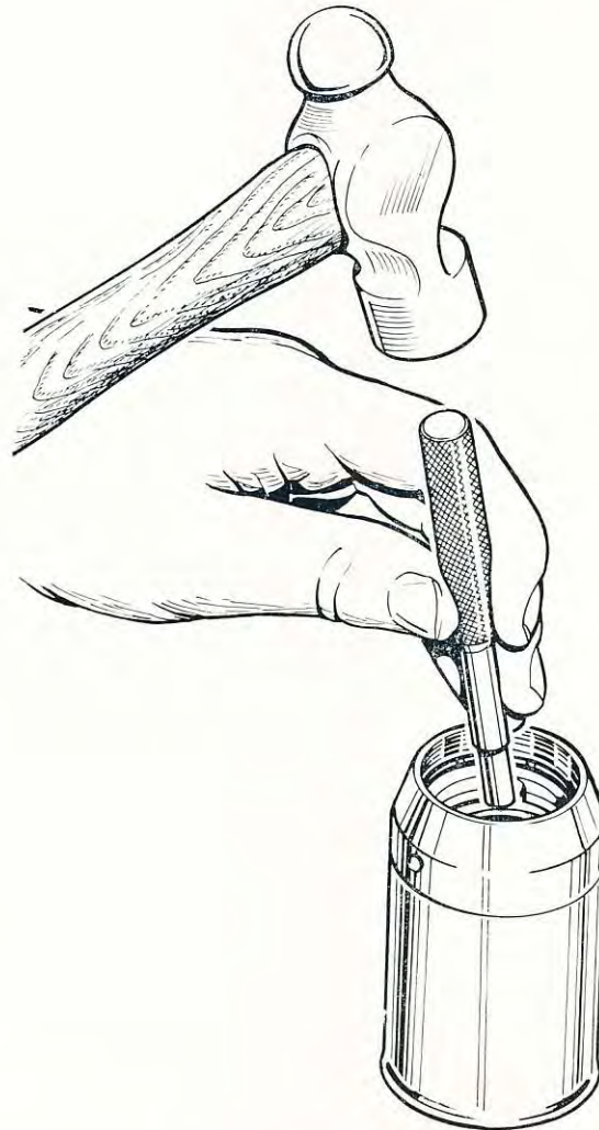
FIG. E10. Removing oil seal.
