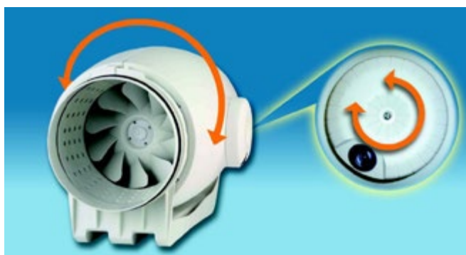
Il corpo del TD-SILENT ruota sul proprio asse di 190° circa per una più facile installazione, mentre la scatola della morsetti è orientabile a 360° per facilitare l'ingresso del cavo di alimentazione.
