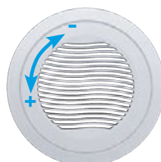
Apertura (+) o chiusura (-) dell'otturatore (posizione chiusa, 1 o 2)
