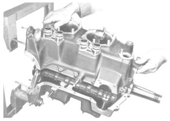
Figure 35 Installing Crankcase 1,3 Side on 2,4 Side
