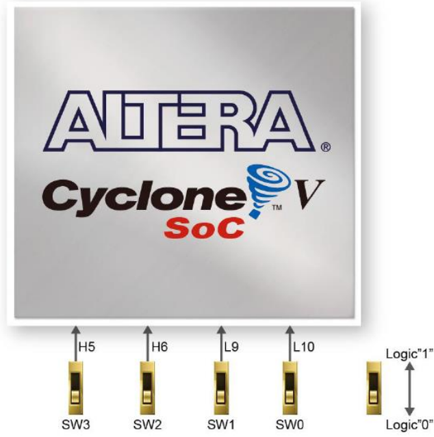
Resim 3-16 Slide Anahtarı ve Cyclone V SoC FPGA arasındaki bağlantılar
