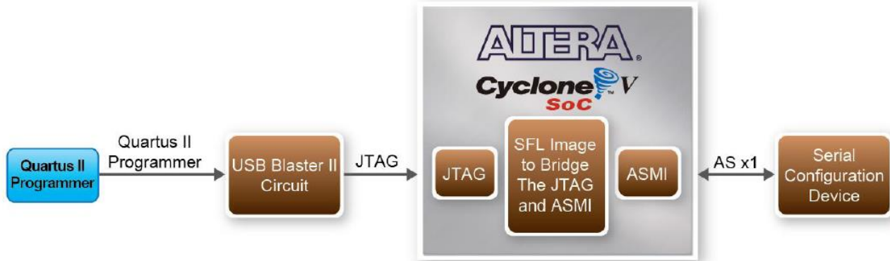
Resim 3-9 SFL Çözümü ile bir Seri yapılandırma cihazı programlamak
