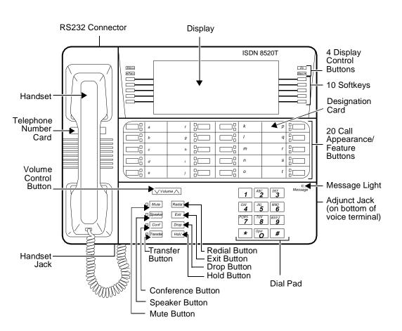
Figure 16-6. The ISDN 8520T Voice/Data Terminal
