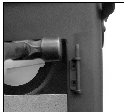
Fig. 13. Adjusting the door hinge
