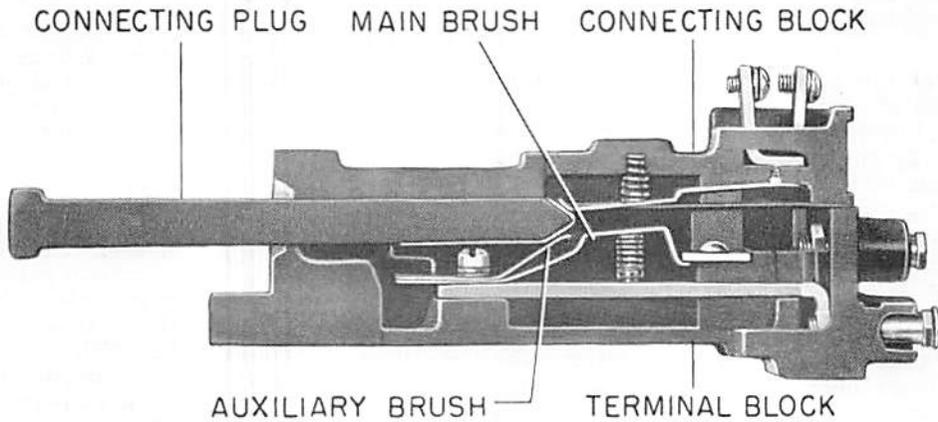
NOTE: AFTER ENGAGING AUXILIARY BRUSH, CONNECTING PLUG TRAVELS 1/4 INCH BEFORE ENGAGING THE MAIN BRUSH ON THE TERMINAL BLOCK.
