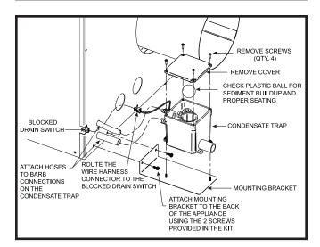
FIG. 73 Install Condensate Trap
