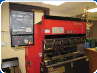
Amada FBD-3512 E 35 Ton x 48" Cap. Press Brake
