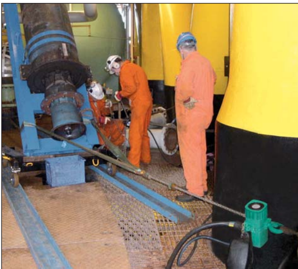
JDN air hoist mini 1000 handling an oil pump.
