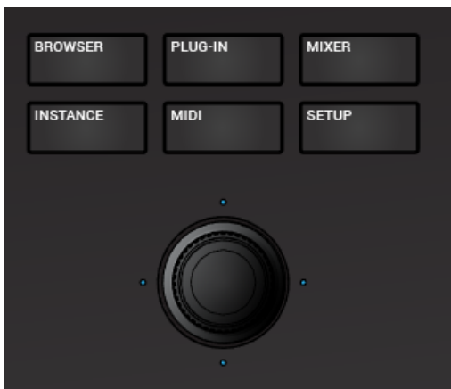
L'encodeur 4D situé en-dessous des boutons Mode.
