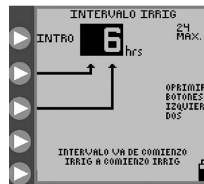
Figura 12C. Configuración del intervalo de irrigación.
