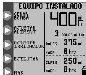
Figura 7D. Menú inicial para el modo de alimentación intermitente con un equipo para alimentación e irrigación.
