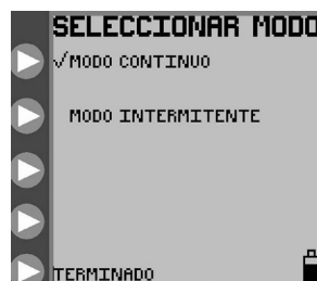
Figura 10B. Menú SELECCIONAR MODO para la selección del modo continuo o intermitente.
