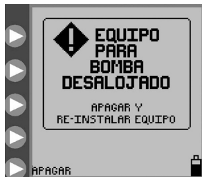
Figura 31. Pantalla de equipo para bomba desalojado.
