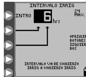
Figura 14C. Configuración del intervalo de irrigación.
