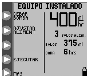
Figura 7C. Menú inicial para el modo de alimentación intermitente con un equipo de sólo alimentación.
