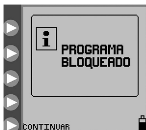
Figura 16. Pantalla PROGRAMA BLOQUEADO, que indica que la bomba está en el modo BLOQ AJUSTES.
