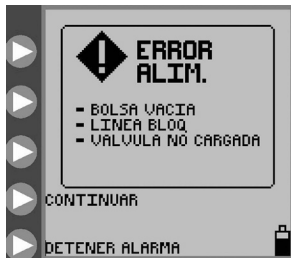
Figura 28. Pantalla de error de alimentación.
