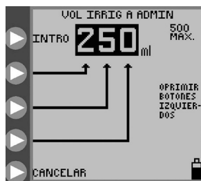
Figura 12B. Configuración del volumen de irrig.
