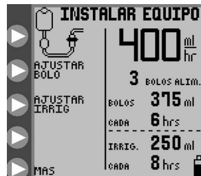
Figura 5B. CARGAR EQUIPO pantalla inicial del menú del modo de alimentación intermitente (EZMODE no está activado).
