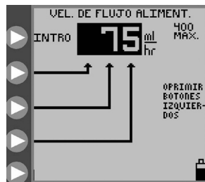
Figura 11B. Configuración de la veloc de aliment.
