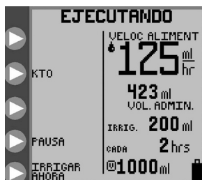
Figura 15A. Pantalla de modo EJECUTANDO para el modo continuo de alimentación.
