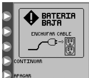
Figura 32. Pantalla de error de batería baja. Indica que es necesario volver a cargar la batería inmediatamente.
