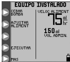
Figura 7A. Menú inicial para el modo de alimentación continua con un equipo de sólo alimentación.
