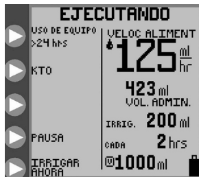
Figura 34. Pantalla Ejecutando con el indicador > 24 H de uso de bomba en la parte superior izquierda de la pantalla.
