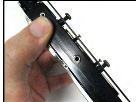
El disco duro se encuentra en cuatro puestos cortos: línea los puestos hasta los agujeros sobre el nuevo disco duro.
