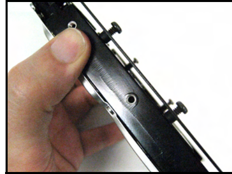
Le disque dur est à quatre postes: aligner les postes aux trous sur le nouveau disque dur.
