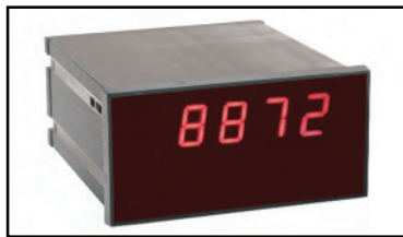
Dimensiones 144 x 72 x 170 mm (depth of embedding including wirings / profundidad de empotrado incluidos los cableados) Drilling template (Plantilla de taladrado): 67x139mm
