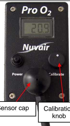
Fill O 2 Analyzer
