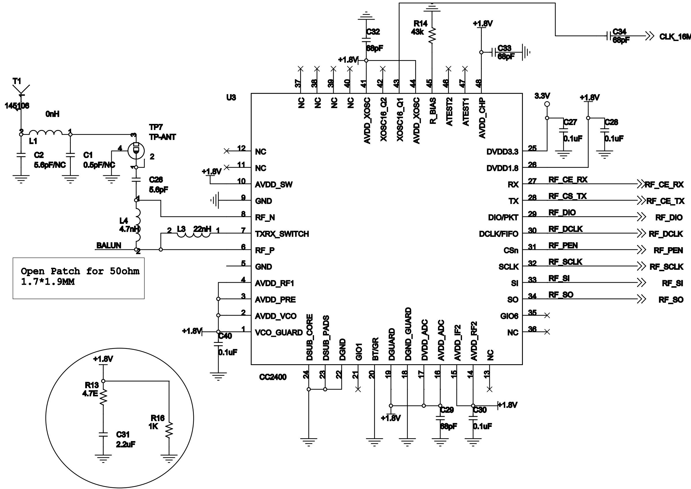
RADIO - RECEIVE BOARD - CIRCUIT DIAGRAM - PART2
