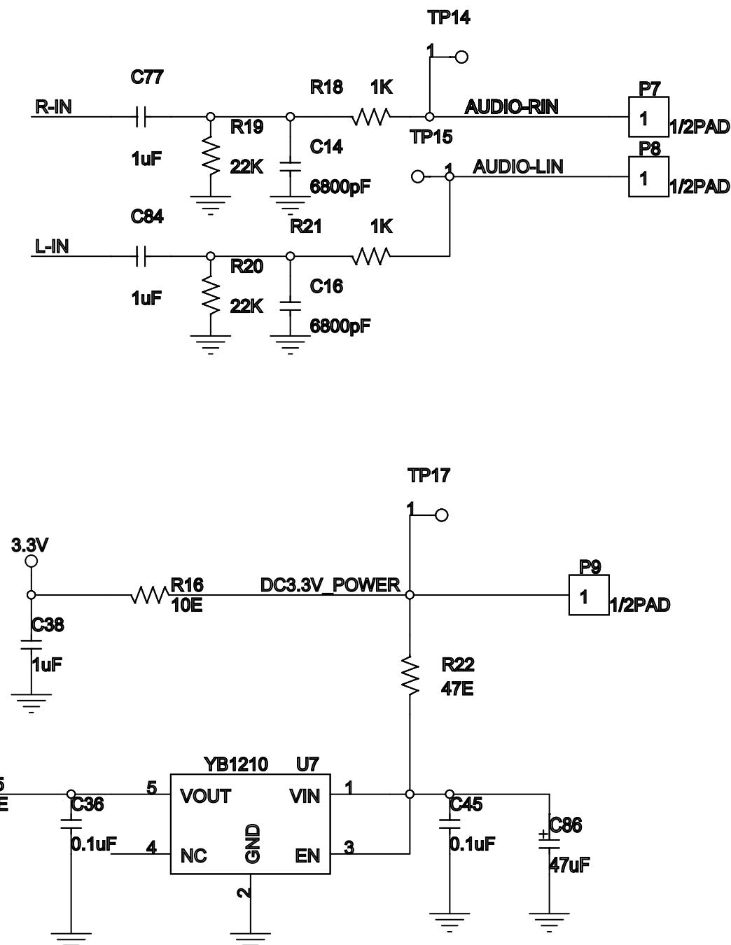
RADIO - TRANSMIT BOARD - CIRCUIT DIAGRAM - PART3
