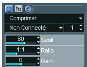
Ce compresseur MIDI sert à “niveler” ou à “exagérer” les différences de vélocité. Le résultat est similaire à celui obtenu avec le paramètre de piste Compression de Vélocité, mais ce plug-in présente ses commandes d'une façon plus proche de celle en vigueur sur les compresseurs audio habituels. Voici ses paramètres :
