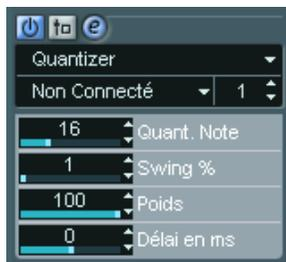
La quantification est une fonction permettant de modifier le timing des notes en alignant leurs emplacements sur une “grille de quantification”. Cette grille peut consister, par exemple, en doubles croches régulières (dans ce cas, les notes possèdent un timing parfait “à la double croche”), mais peut aussi être moins régulière (ce qui permet de conférer au timing de vos notes un feeling de swing, etc.).
