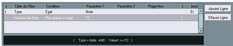
La liste du haut est celle où on configure les conditions de filtrage, ce qui détermine les événements à trouver. La liste contient une ou plusieurs conditions, chacune sur une ligne séparée.
