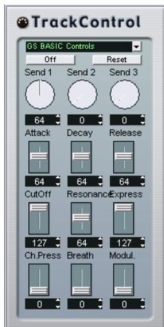
L'effet Track Control contient trois panneaux de contrôle prêts à l'emploi pour régler les paramètres d'un périphérique MIDI compatible GS ou XG. Les protocoles GS (signé Roland) et XG (signé Yamaha) sont des extensions du standard General MIDI, offrant davantage de sons et un contrôle plus élaboré des divers paramètres de l'instrument. Si votre instrument est compatible GS ou XG, l'effet Track Control permet d'ajuster ses sons et ses effets depuis Nuendo.
