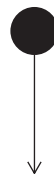
Figura 3-2 El círculo relleno se llama nodo inicial —o punto de inicio del diagrama de actividades— y la flecha dirigida se llama flujo de control .
