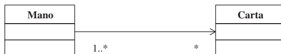
Figura 5-8 “Mano” y “Carta” están asociados de manera unidireccional, lo cual significa que “Mano” tiene un atributo “Carta”.
