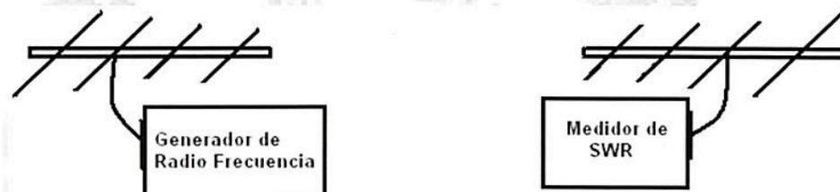
Figura 3.1.- Arreglo para obtener la respuesta a la frecuencia de una antena Yagi Uda.
