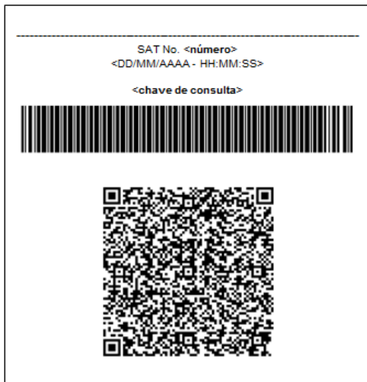
Figura 7 – Exemplo de rodapé de extrato de CF-e-SAT em bobina contínua de papel largo (8cm) com o código de barras representando 44 caracteres.
