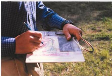
A posição dos elementos pode exigir medições com bússola e passos, ou até trigonometria, para calcular distâncias de maneira semelhante à topografia na espeleologia e outros campos. Nesse sentido, há mapeadores que continuam com o método tradicional, outros combinam o tradicional com o GPS e alguns estão dando o passo a 100% tecnológico.
