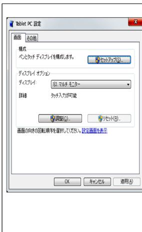
Windows® 標準の設定ウィンドウが表示されます。**セットアップ**にてディスプレイがタッチスクリーンであることを認識させます。
