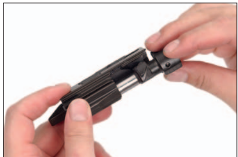
Figure 51: Remove bolt head (pull)
