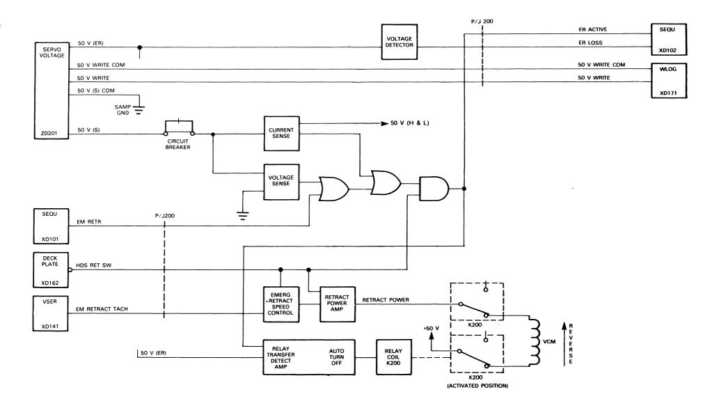
FIGURE 3-39. SERVO POWER AMPLIFIER PCB, EMERGENCY RETRACT OPERATION
