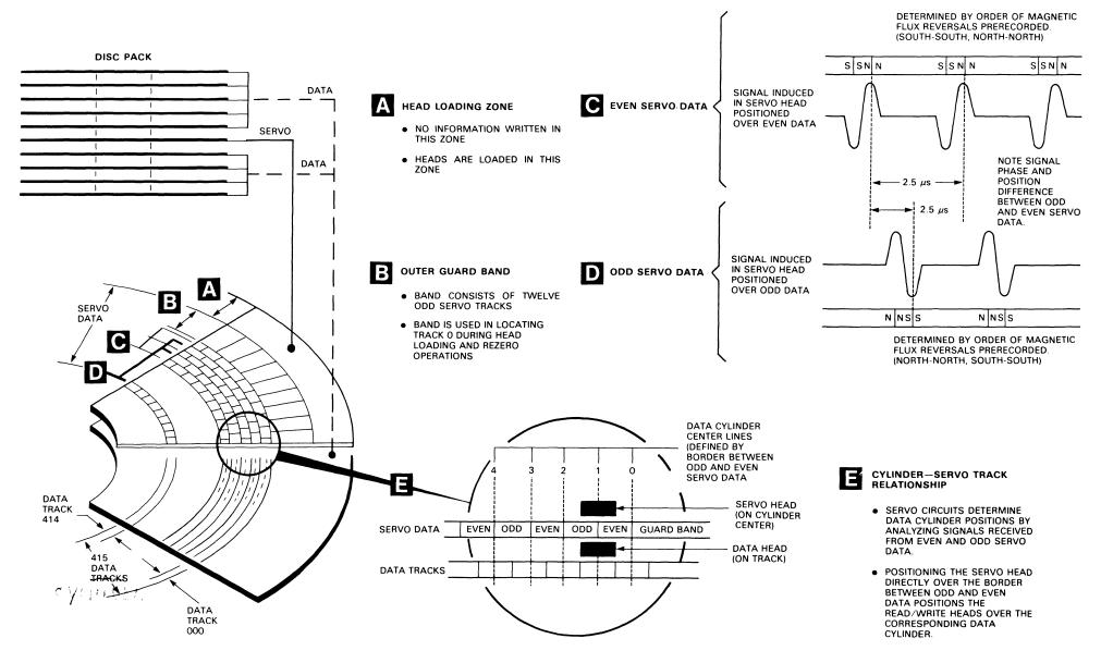
FIGURE 3-27. SERVO SURFACE FORMAT
