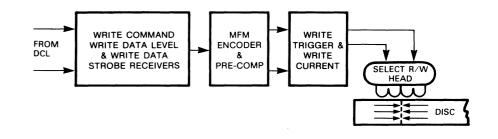
FIGURE 3-60. SIMPLIFIED WRITE OPERATION
