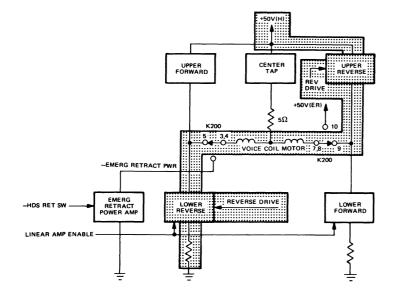
FIGURE 3-37. POWER AMP IN VELOCITY CONTROL MODE, REVERSE
