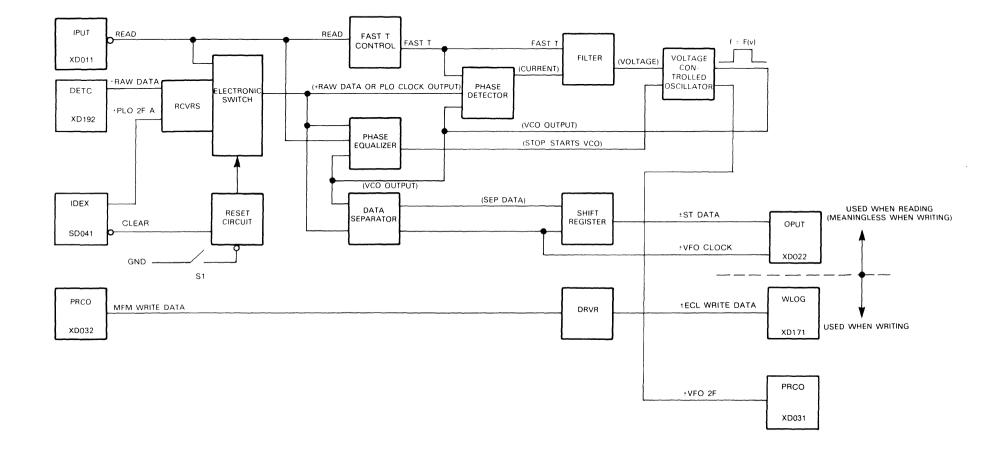
FIGURE 3-13. VARIABLE FREQUENCY OSCILLATOR PCB (VFO)
