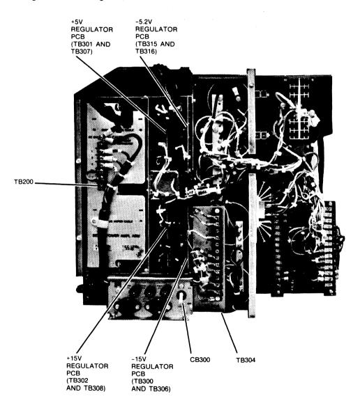
FIGURE 2-7. REAR VIEW, POWER SUPPLY COVER OFF
