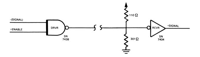
FIGURE 1-19. SINGLE-ENDED LINE DRIVERS AND RECEIVERS
