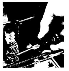
FIGURE 4-9. USING HEAD TORQUE TOOL
