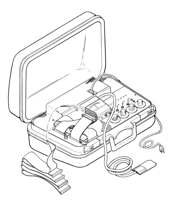
FIGURE 1-3. MEMOREX 800 DISC STORAGE SUBSYSTEM TESTER
