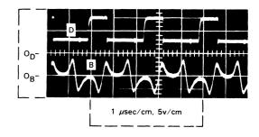
FIGURE 3-58. SERVO SYSTEM WAVEFORMS (Part 1 of 6) - TRACK FOLLOWING
