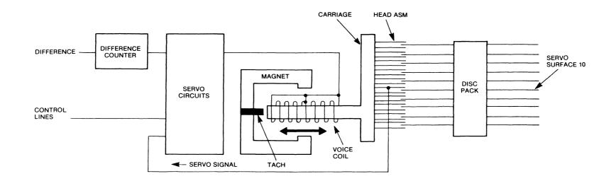
FIGURE 3-20. SERVO SYSTEM BASIC ELEMENTS
