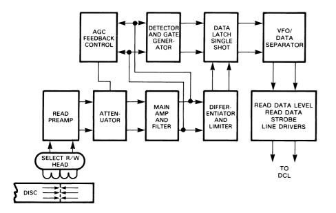
FIGURE 3-61. SIMPLIFIED READ OPERATION
