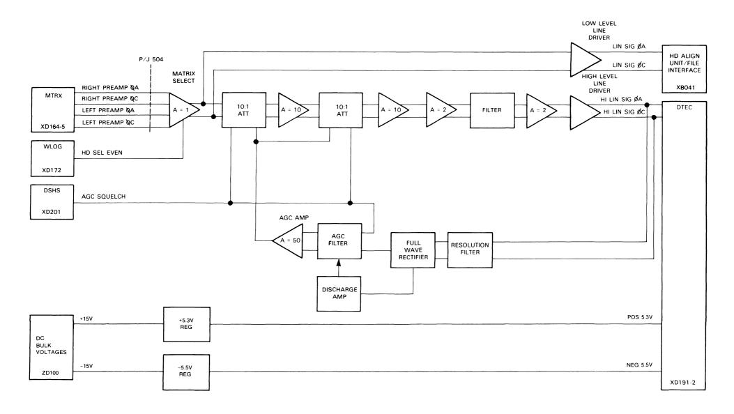
FIGURE 3-65. LINEAR AMP PCB
