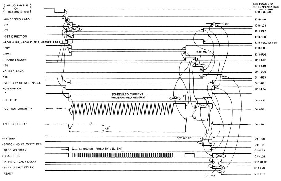
FIGURE 3-55. 677 SERVO TIMING DIAGRAM-REZERO FROM TRACK 53
