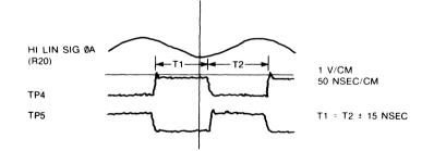
FIGURE 3-70. BIDIRECTIONAL ONE SHOT, DATA LATCH
