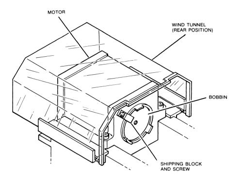
FIGURE 2-6. LINEAR MOTOR SHIPPING BLOCK
