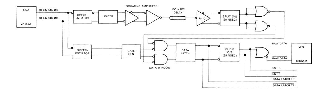
FIGURE 3-66. DETECTOR PCB
