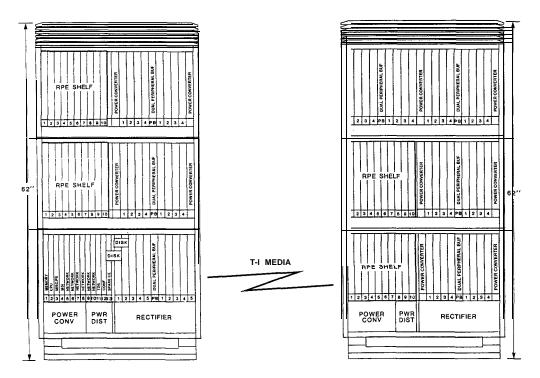
FIGURE 5-47: MERIDIAN SL-1ST - TYPICAL RPE CONFIGURATION
