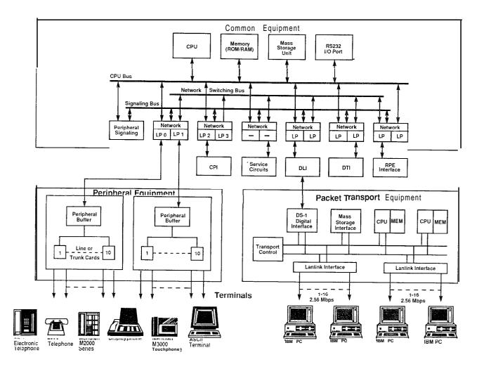
FIGURE 3-16: MERIDIAN SL-1 SYSTEM ARCHITECTURE
