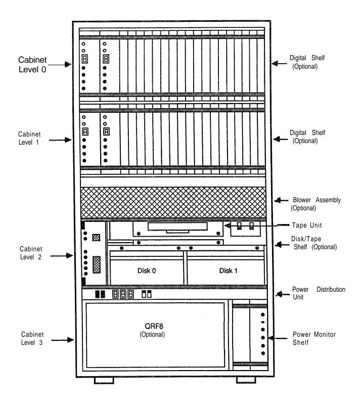
FIGURE 5-55: PACKET TRANSPORT CABINET CONFIGURATION
