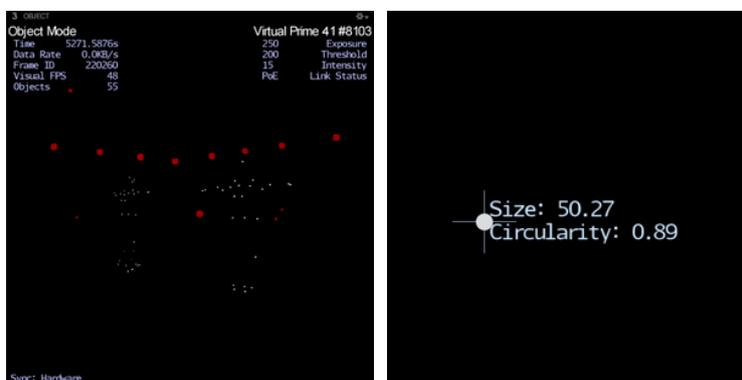
通过 2D Object 数据以及相机标定信息可以计算出 3D 数据，将 2D 质心转化为 3D 坐标的过程称为 Reconstruction。
