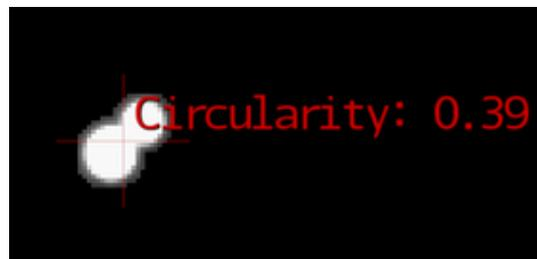
了能会 Circularity Filter 过滤，为获得最佳捕捉效果尽量设置合适的 Marker 点间距。
