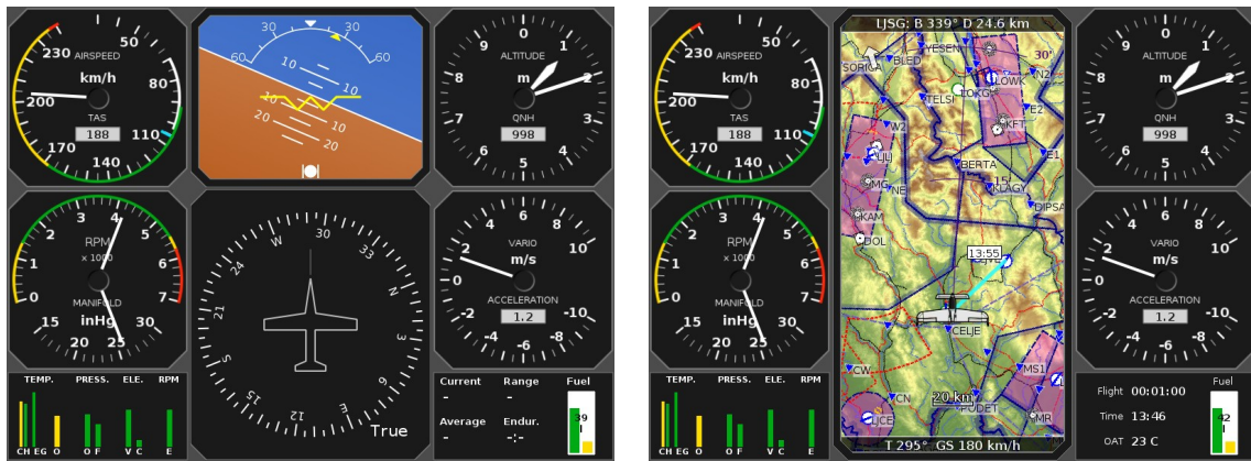
Figura 45: Ejemplo "AHRS + HSI" a la izquierda y ejemplo del "sólo mapa móvil" a la derecha.
