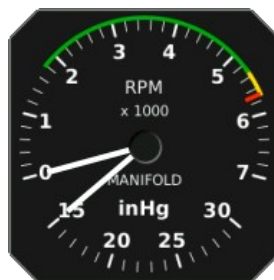
Figura 36: La combinación de RPM y el indicador de presión del colector.
