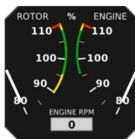
Figura 38: La combinación de RPM del rotor y las RPM del motor. Ambas escalas son en porcentajes.
