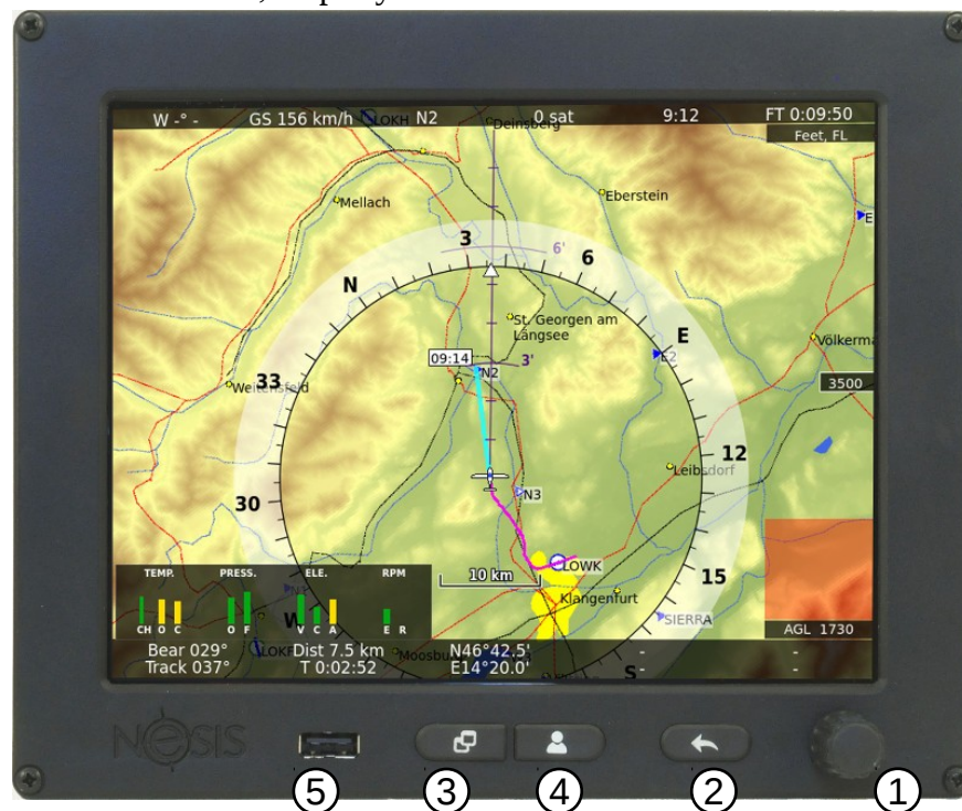
Figura 4: Organización del panel frontal NESIS.
