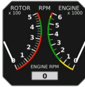
Figura 37: La combinación de RPM del rotor y RPM del motor.
