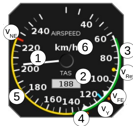
Figura 32: Anemómetro optimizado para un avión que utilice flaps de aterrizaje de dos etapas.
