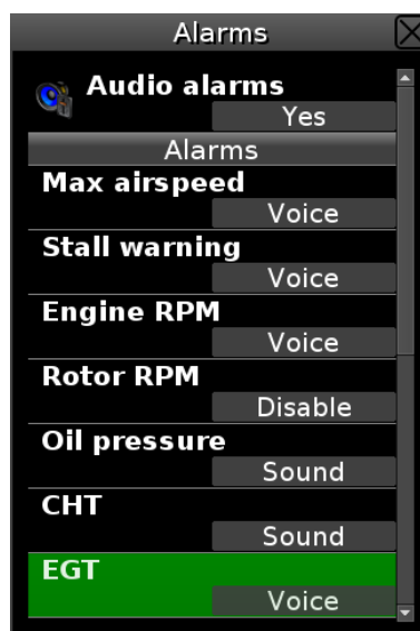
Figura 26: Opciones de alarma. Cada alarma se puede configurar de forma individual.
