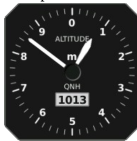
Figura 34: El indicador de altitud con la escala dada en metros.
