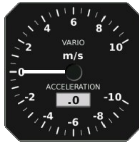
Figura 35: La versión métrica del variómetro utilizado en el NESIS.
