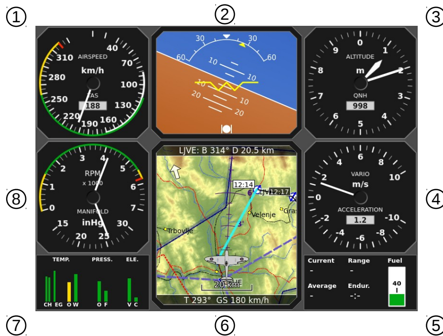
Figura 7: Ilustración de la pantalla de información de vuelo clásico..
