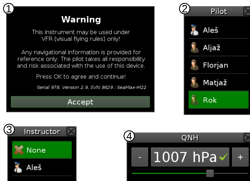
Figura 5: Secuencia típica de encendido
