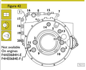
SEQUENCE FOR TIGHTENING THE FLYWHEEL HOUSING FASTENING SCREWS
