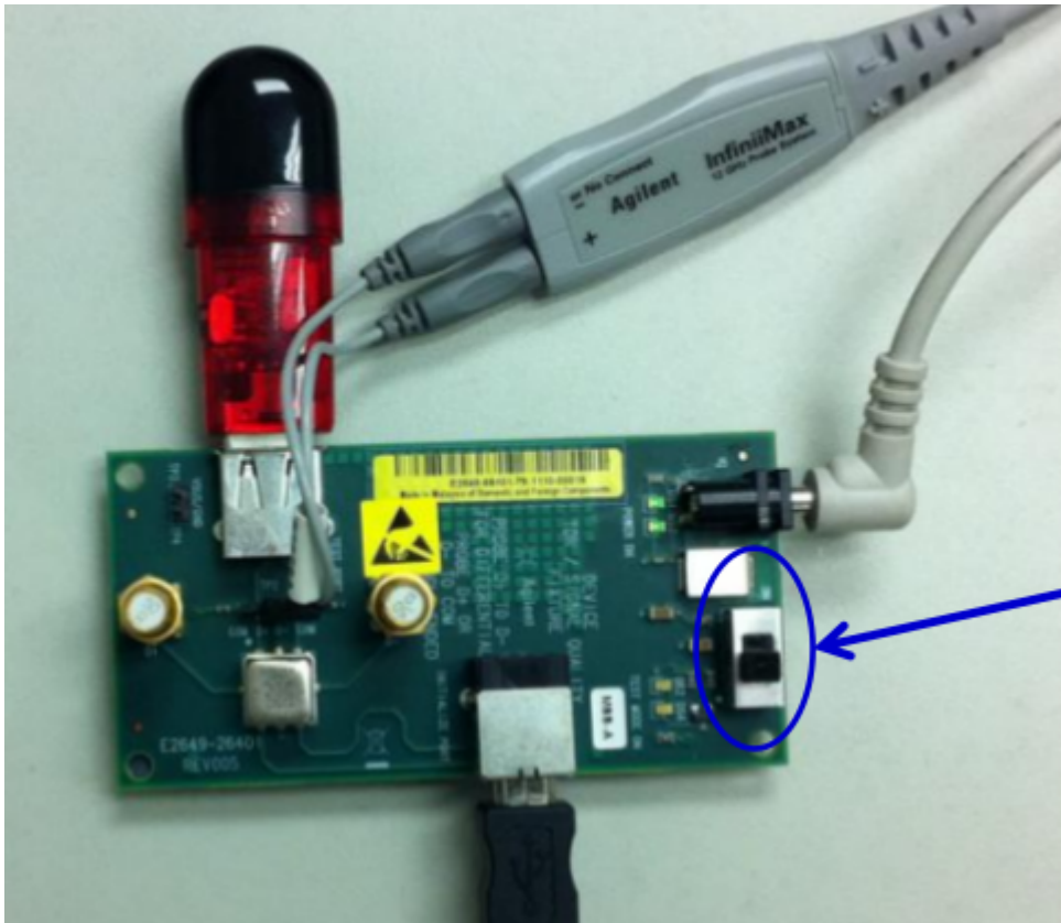
图1-5 Agilent USB 2.0 SQ测试夹具连接方法
