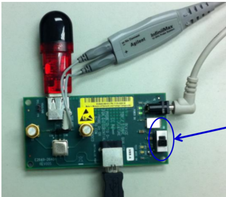
图1-5 Agilent USB 2.0 SQ测试夹具连接方法
