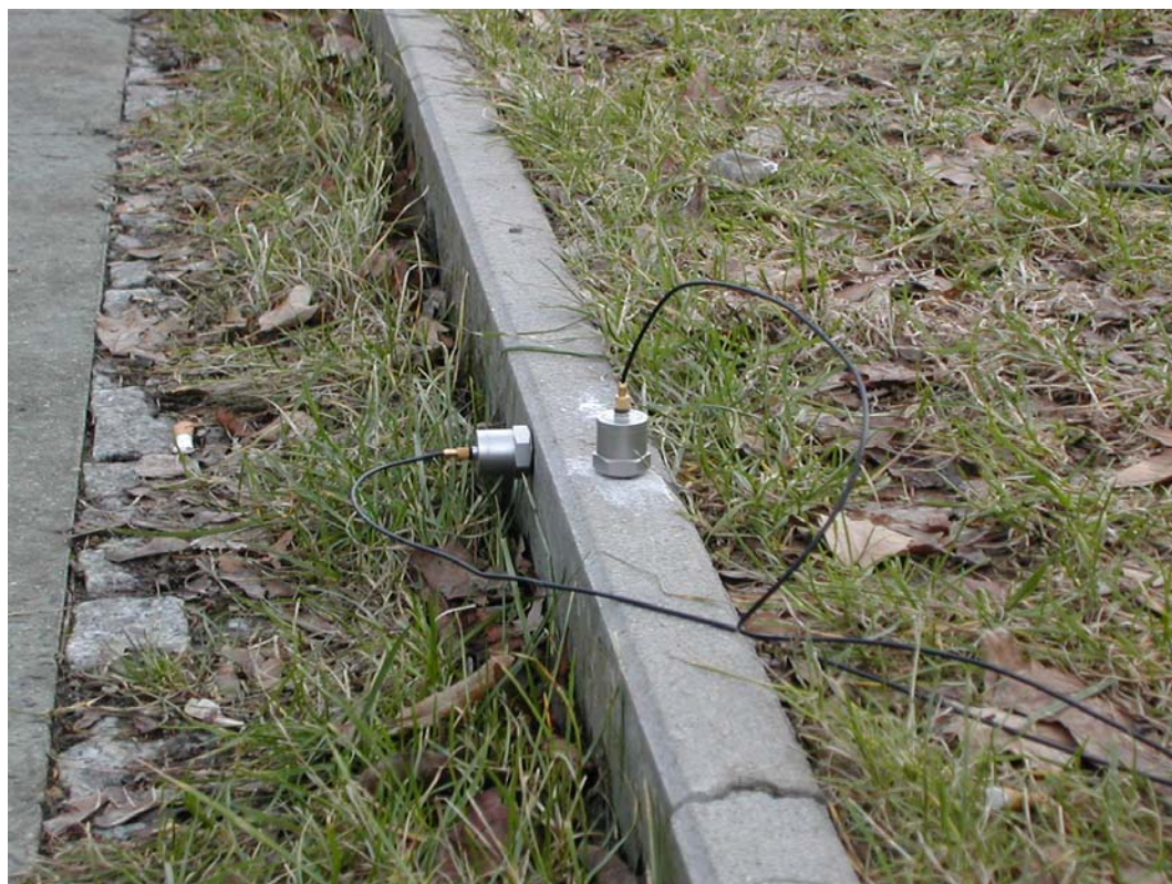
Fissaggio accelerometri sul cordolo.
