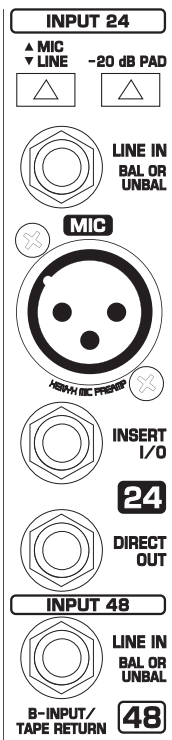
Fig. 7.8: A- und B-Kanal-Eingangssektion
