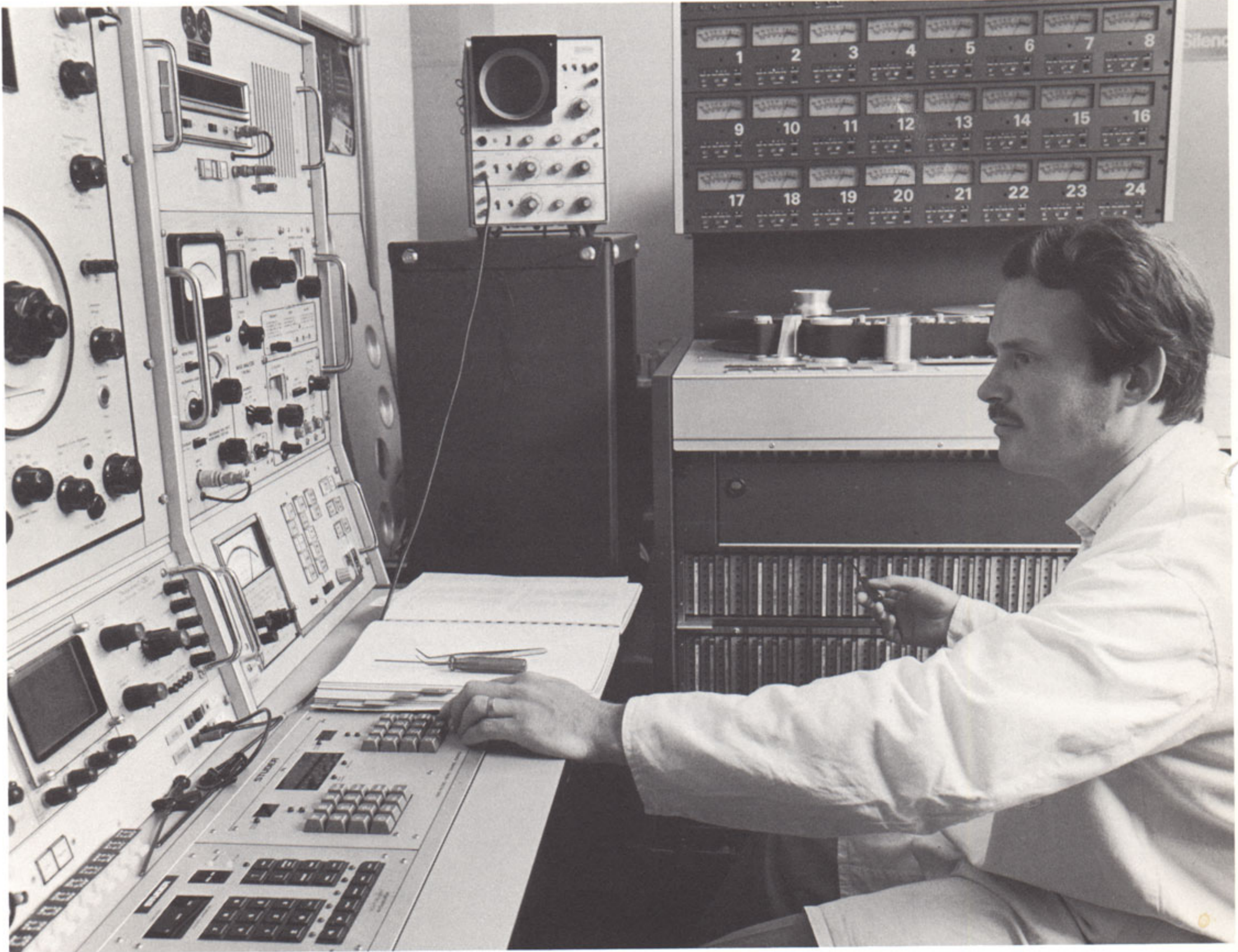
4. Jede A800 wird nach Kundenspezifikationen eingestellt. Abschliessend werden alle garantierten Daten vollständig geprüft. 4. Each A800 is aligned according to the customers indications. Finally the guaranteed specifications are completely checked.
