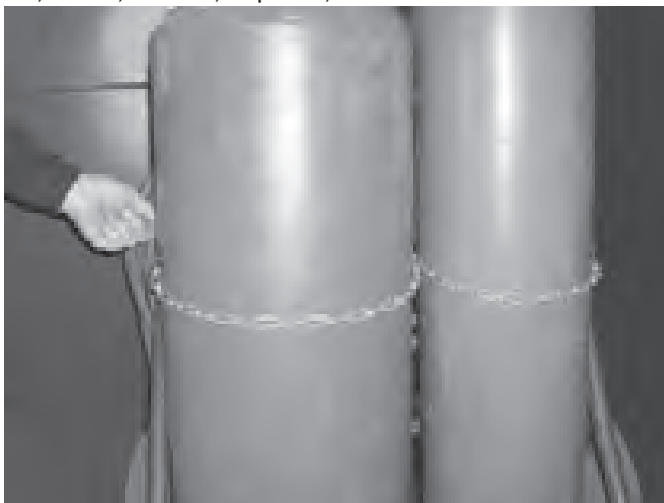
Figure 8: Blocage des bouteilles sur un chariot
