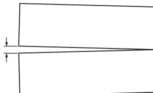
SÉPARATION DES EXTRÉMITÉS EN COURS DE SOUDAGE
