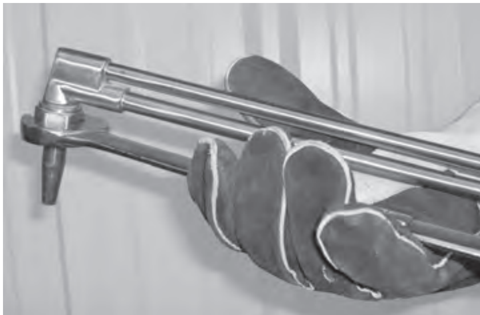
Figure 17: Serrage de l'écrou de la buse
