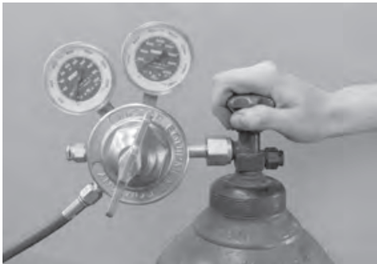
Figure 10: Ouverture du robinet de la bouteille
