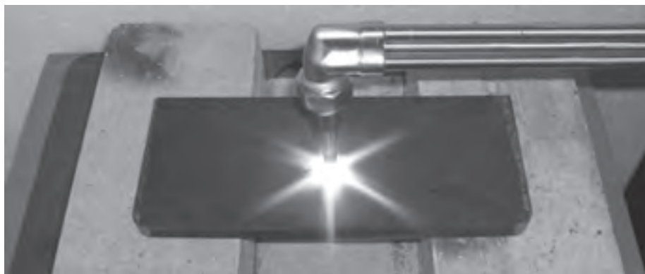
Figure 20: Démarrage du perçage
