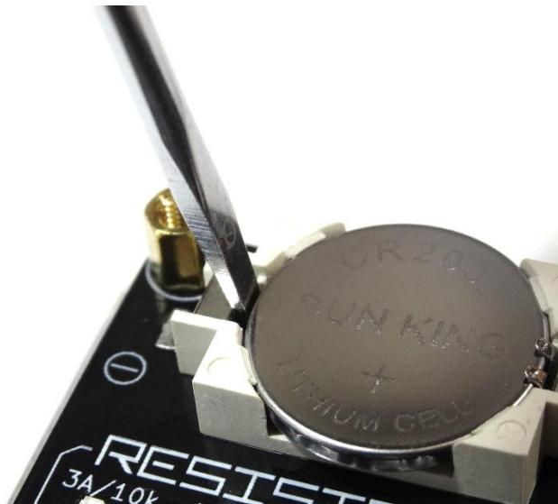
LED が点かなくなったり、暗くなったりしたら電池の交換時期です。上記画像のようにマイナス端子と電池の隙間にマイナスドライバーの先を滑り込ませるようにしてテコの原理を利用して外します。その後、新しい CR2032 バッテリーのプラス側を上にして装着します。
