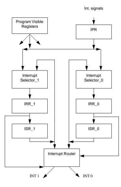
Figure 2-9. MPIC Block Diagram
