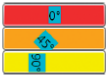
Рис. 4.10. Для внутренних элементов TextBlock , повернутых вокруг левого верхнего угла, явно задан цвет фона
