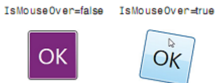
Рис. 14.3. Простой триггер свойства может изменять визуальное представление кнопки при наведении на нее указателя мыши
