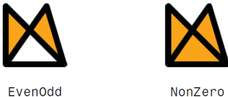
Рис.15.7. Изображение перекрывающихся треугольников при различных значениях PathGeometry.FillRule
