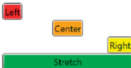
Рис. 4.4. Влияние HorizontalAlignment на размещение кнопок на панели StackPanel .
