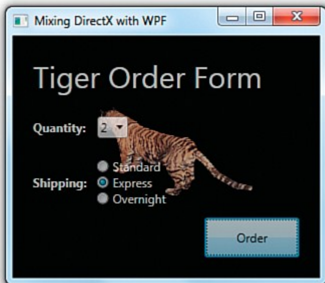
Рис. 19.11. Окно WPF Window, содержащее трехмерное изображение вращающегося тигра, полученное с помощью DirectX, а поверх него элементы управления WPF
