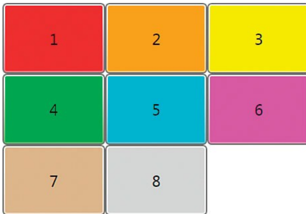
Рис. 5.17. Восемь кнопок на панели UniformGrid
