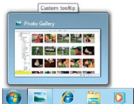
Рис. 8.12. Всплывающая подсказка, заданная с помощью TaskbarItemInfo.Description
