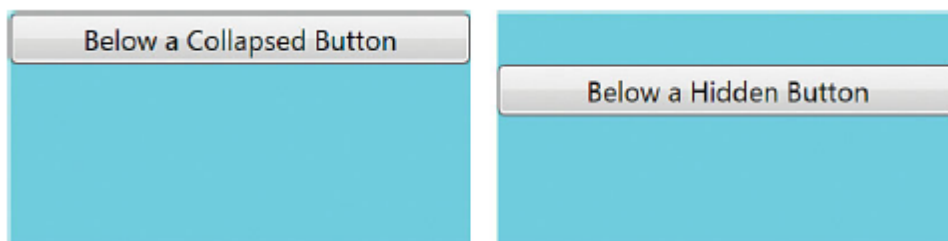
Рис. 4.3. Скрытая кнопка занимает место на экране, а свернутая - нет
