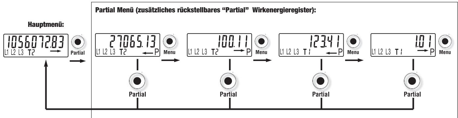
Nach Betätigung der "Partialtaste" in beliebiger Position der Wirkenergieregister von 4 Sek. werden alle Partial-Wirkenergieregister für die Nullsetzung aufgerufen.
