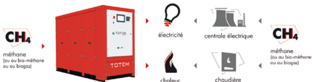
Le TOTEM 20 utilise 6,3 m<sup>3</sup> de gaz naturel pour la production de 20 kW d'énergie et de 42 kW de chaleur par rapport à une chaudière qui a besoin de 9,3 m<sup>3</sup> pour le même but.
