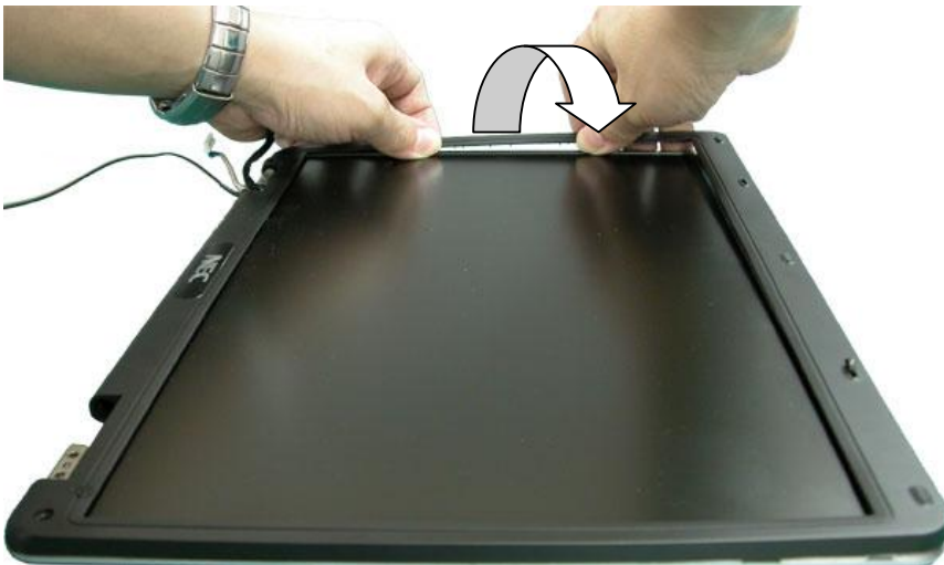
Fig. 30 Removing the LCD Bezel
