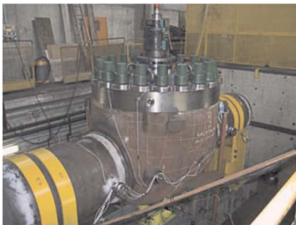
Кран BT2 38 дюймов (950 мм) армирован во всех смачиваемых деталях по API 5000 в ходе испытаний на изгиб.
