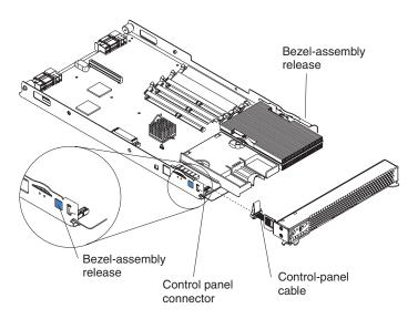
Figure 17. Blade server bezel placement
