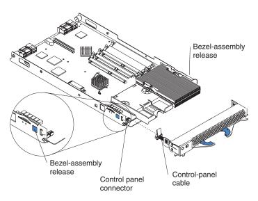
Figure 16. Blade server bezel placement
