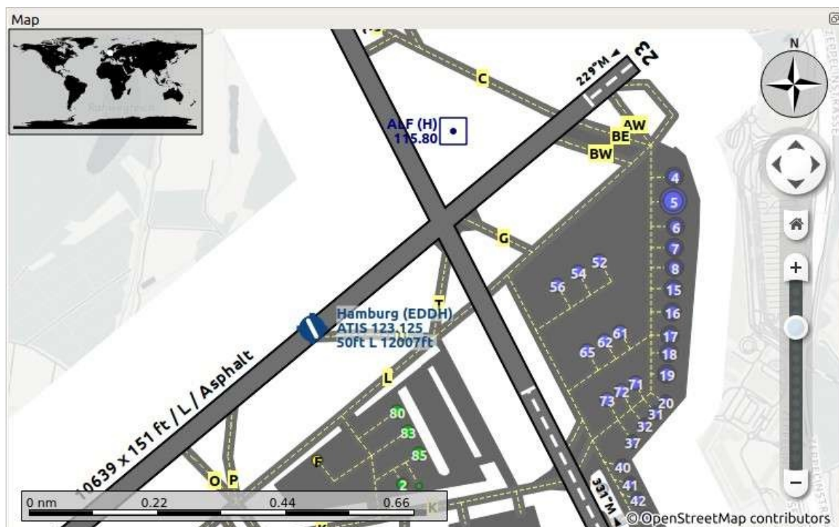
Image ci-dessus: Vue détaillée du diagramme de l'aérodrome. Affiche des portes bleues à droite et quelques rampes de stationnement vertes de l'aviation générale à gauche. Le long seuil déplacé de la piste 33 est visible. Les lignes en pointillés jaunes indiquent les trajets en taxi.
