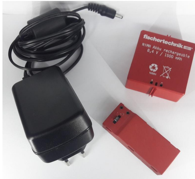
Abbildung 1.7: Für den ftDuino empfohlene Original-fischertechnik-Stromversorgungen
