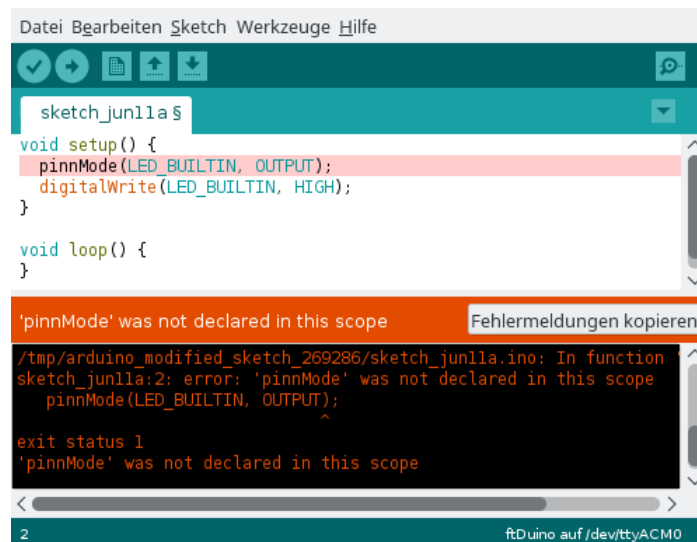
Abbildung 4.5: Anzeige eines Übersetzungsfehlers
