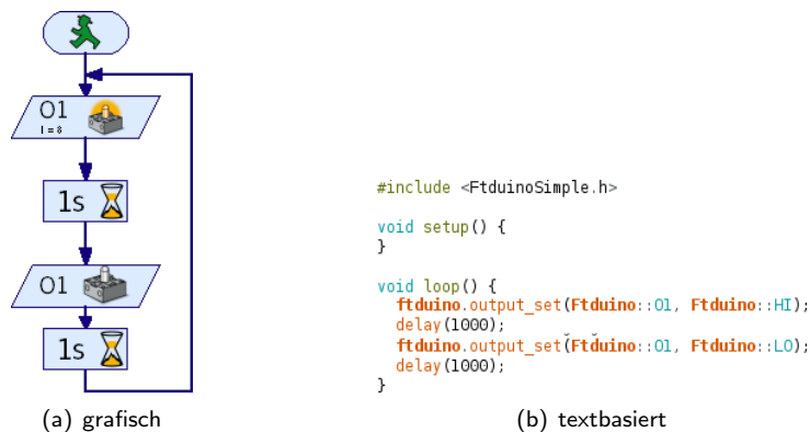
Abbildung 4.1: Blinken einer Lampe an Ausgang O1
