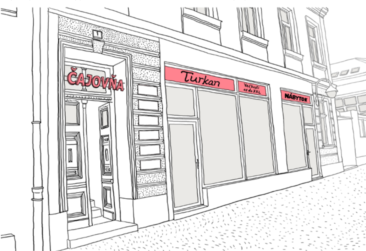
▲ Sch. 3 Na umiestnenie názvu prevádzkarne sa odporúča využiť vyhradený nápisový pás pod kordónovou rímsou prízemia, u prevádzkarní s výkladom nápisové pole výkladu. Štúrova ulica.
