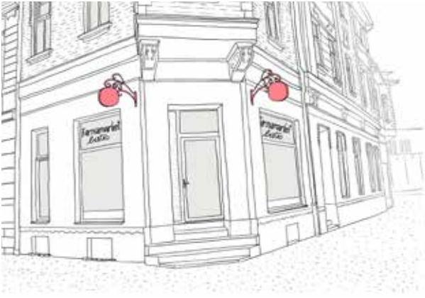
▲ Sch. 5 V prípade nárožnej budovy je možné použiť dve výstrče. Sládkovičova ulica.
