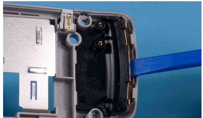
32) Use SS-93 Tool to remove ANTENNA.
