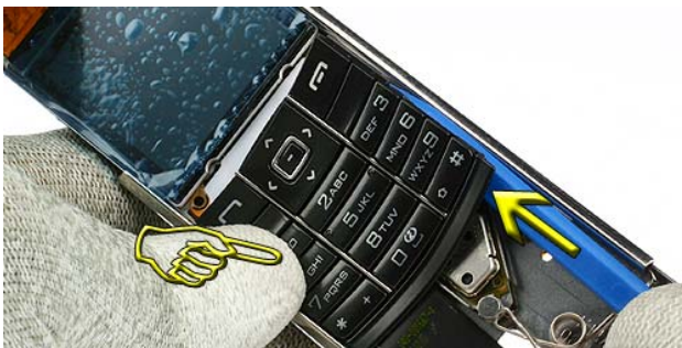
27.) ... till the Keymat flips out.
