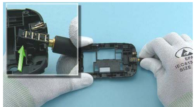
28) Remove the AV JACK with an AV plug.
