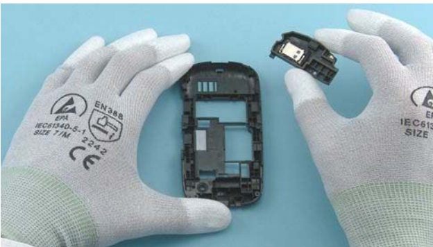
31) Remove the MAIN ANTENNA.
