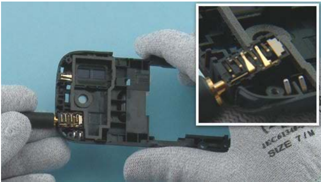
31) Use an AV plug to lever the AV JACK out and remove it.
