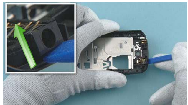
28) Use the SS-93 to lever out the AV JACK.
